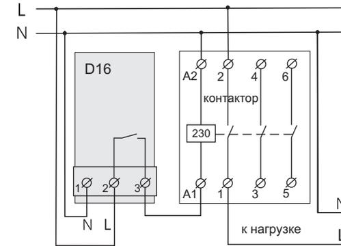
Схема 3. Подключение реле напряжения и контактора с обмоткой 230 В
