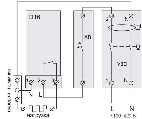
Схема 2. Подключение автоматического выключателя и УЗО
