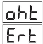
На екрані 1 раз / сек. буде блимати «**ohT**» (перегрів). У цей час натискання середньої кнопки виведе на екран температуру датчика термозахисту. Коли температура всередині корпусу опуститься нижче 60 °C — реле включить навантаження та відновить роботу.
