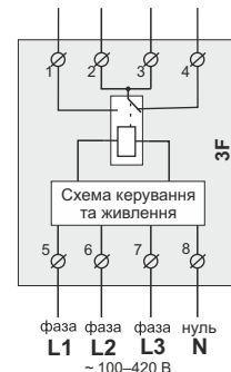
Схема 1. Спрощена внутрішня схема і схема підключення
