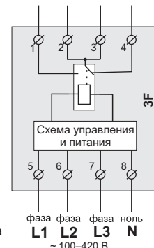
Схема 1. Упрощенная внутренняя схема и схема подключения
