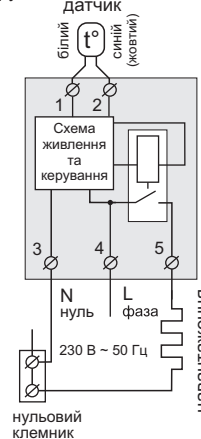
Схема 1. Спрощена внутрішня схема і схема підключення
