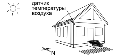
Рисунок 1. Монтаж датчика температуры воздуха
