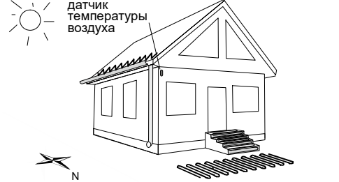
Рисунок 1. Монтаж датчика температуры воздуха
