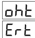
На екрані 1 раз / сек. буде блимати «ohT» (перегрів). У цей час натискання середньої кнопки виведе на екран температуру датчика термозахисту. Коли температура всередині корпусу опуститься нижче 60 °C — реле включить навантаження та відновить роботу.
