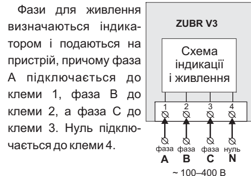
Схема 1. Спрощена внутрішня схема і схема підключення
