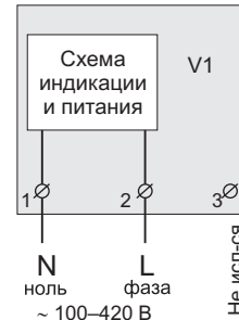
Схема 1. Упрощенная внутренняя схема и схема подключения
