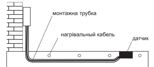
Рисунок 2. Спосіб монтажу датчика опадів при підігріві ґрунту
