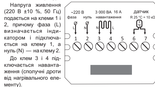
Схема 1. Схема підключення і спрощена внутрішня схема
